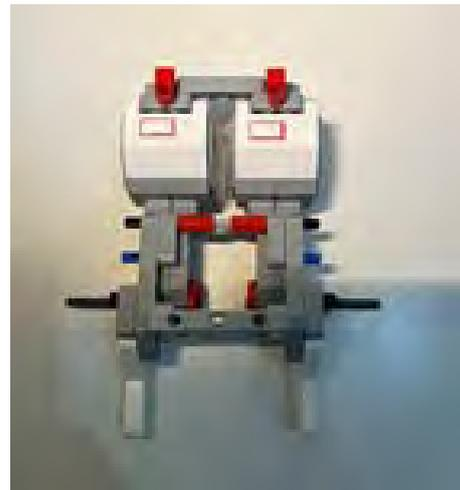
Рисунок 2. Крепления моторов на раму
