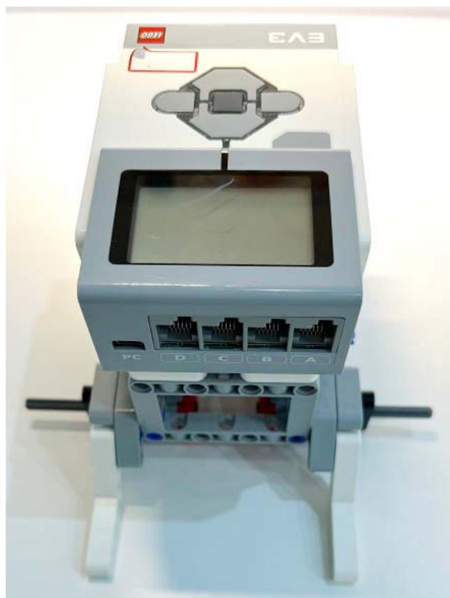
Рисунок 4. Блок процессора
